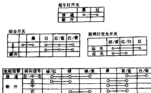
图 4-2-41 奥拓轿车组合开关电路连接
